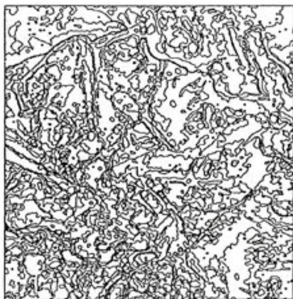
Fig 7 - Analyse d'image de l'éprouvette de la fig 1, image obtenue par superposition des lignes d'isodensité des niveaux de gris de l'image numérisée. Image analysis of the test piece appearing on fig 1. The isodensity lines of gray levels are identified on the numerized image.
