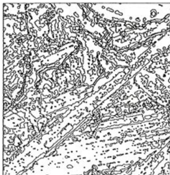
Fig 9 - Analyse d'image de l'éprouvette de la fig 3, image obtenue par superposition des lignes d'isodensité des niveaux de gris de l'image numérisée. Image analysis of the test piece appearing on fig 3. The isodensity lines of gray levels are identified on the numerized image.
